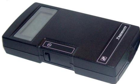
Рисунок 1 – Внешний вид измерителя температуры цифрового переносного ИТ 5 – Т «Термит».
