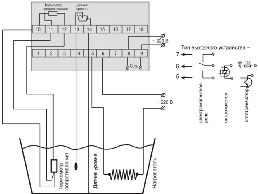
**Схема электрическая подключения
