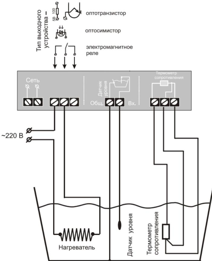
Схема электрическая подключения регулятора температуры РАТАР-02М.ТС-Д1
