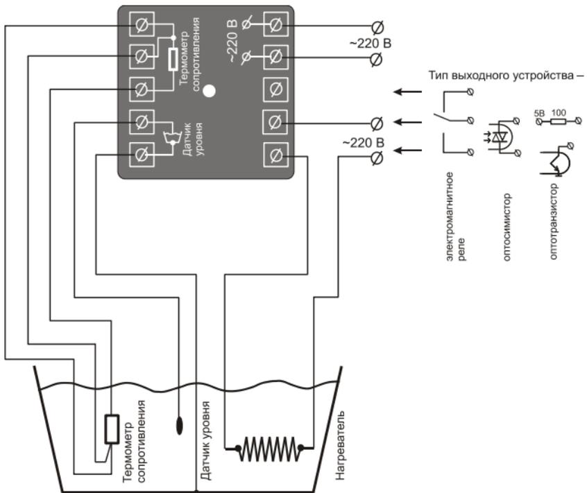
**Схема электрическая подключения регулятора температуры ПАТАР-02М.ТС-Щ3**
