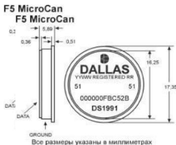
**Ри-сунок 2 – Внешний вид и габаритные размеры измерите-ля–регистратора температуры DS1921.**
