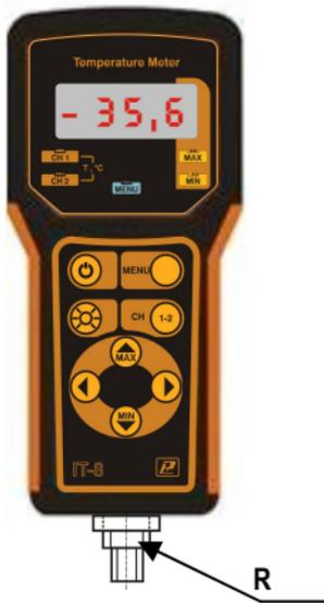
На нижней торцевой поверхности прибора круглый соединитель R
