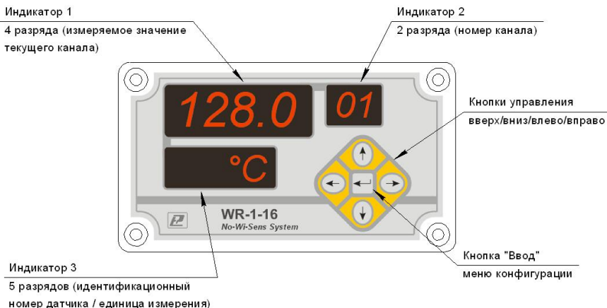
Рисунок 1– Внешний вид лицевой панели и назначение органов управления и индикации измерительного прибора WR–1–16
