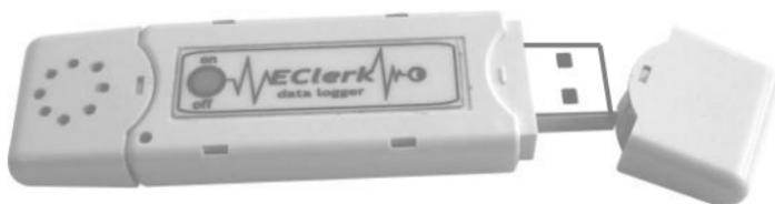
**Рисунок 1 – Внешний вид автономного регистратора температуры ECLerk–USB–T**
